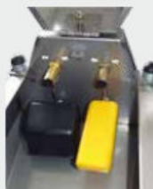
Avec un flotteur supplémentaire Basse Pression (jaune)
