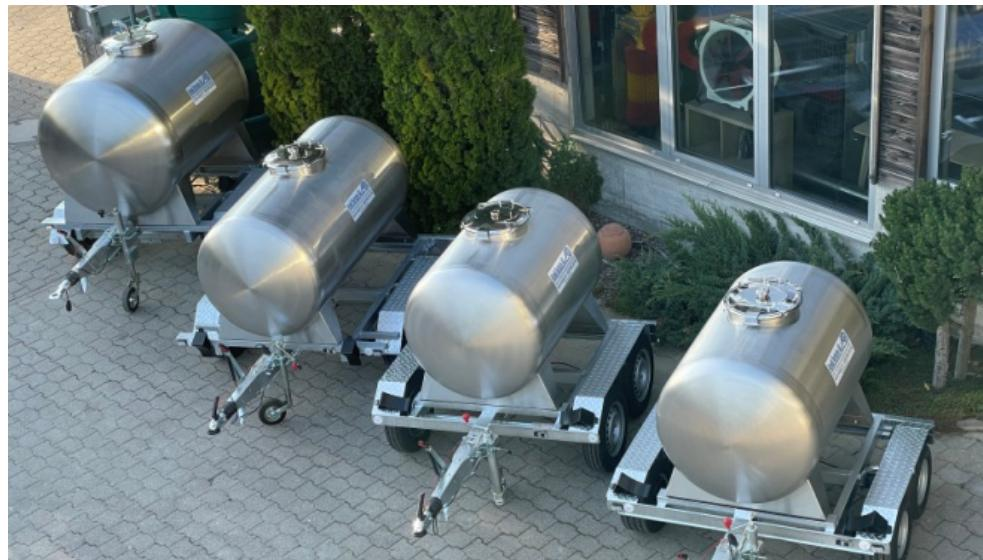
Tanks à lait de haute qualité en acier inoxydable, standard cylindrique couché (sur demande également boule à lait), disponibles dans tous les volumes, nous avons également quelques tanks occasion en stock. Nettoyage facile grâce à la boule de lavage intégrée et en option avec pompe de lavage. Sur châssis galvanisé au feu, avec suspension et éclairage, essieux simple ou tandem (selon le volume).
