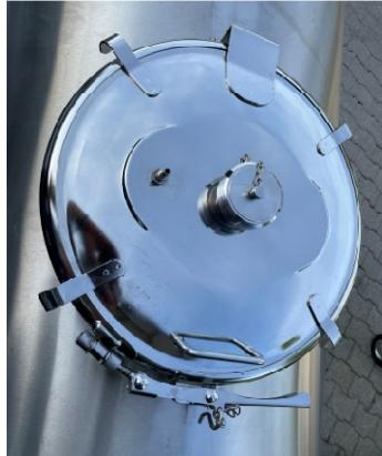
Couvercle avec boule de lavage, s'ouvre facilement d'un seul geste, en option avec vidange à air comprimé
