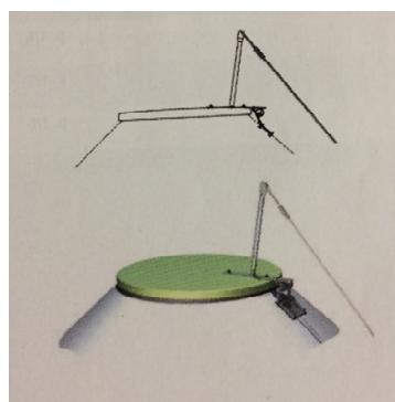
Option: Couvercle avec mécanisme pour l'ouverture du sol
